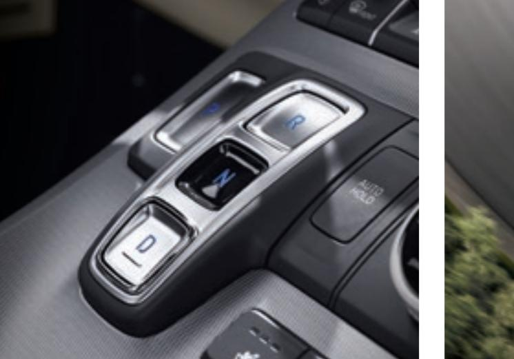
Переключение режимов 8-ступенчатой автоматической коробки передач кнопками
