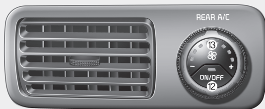
■ Управление системы кондиционирования воздуха в зоне 3-го ряда (для системы кондиционирования тип В)
